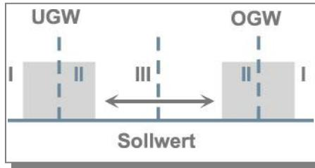
Messdaten werden für die Überwachung von Produkten sowie zum Regeln von Prozessen verwendet. Um dies wirksam machen zu können, ist es wichtig zu wissen, wie groß der durch das Messsystem eingebrachte Fehler ist. Dieser darf einen gewissen Anteil der Prozessstreuung bzw. der zu messenden Toleranz nicht überschreiten.
