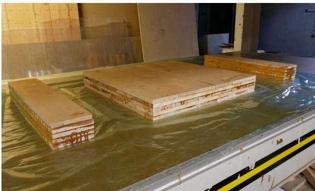
Verklebte und verpresste Holzkerne.
